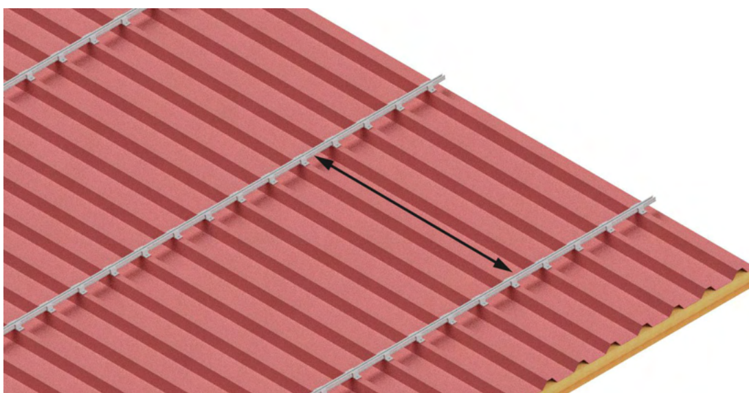
Rysunek 77 Odstęp = Długość modułu + 20 mm
