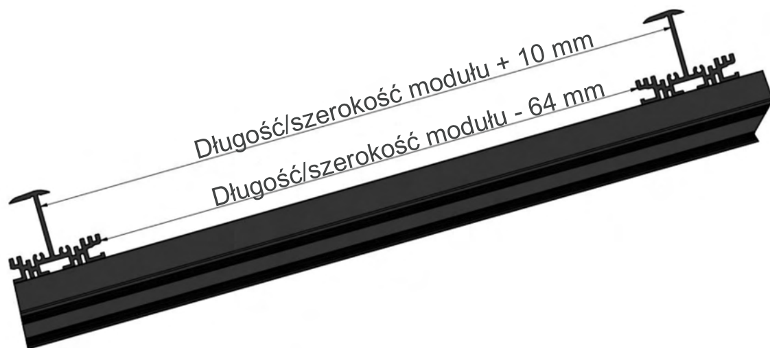
Rysunek 146 Odstęp między szynami wsuwanymi: Długość/szerokość modułu + 10 mm, lub długość/szerokość modułu - 64 mm
